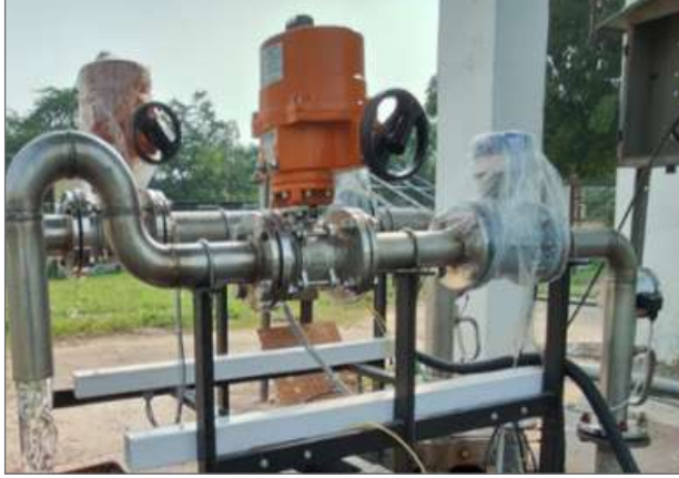
चित्र 3.22: सोलर वॉटर पंपिंग सिस्टम का विश्वसनीयता और प्रदर्शन मूल्यांकन NISE में विश्वसनीयता परीक्षण सेटअप
