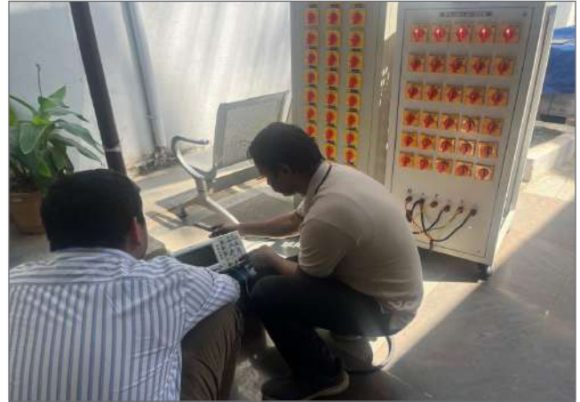
चित्र 4.3: बैंगलोर में 150 kWh BESS प्रणाली का कारखाना स्वीकृति परीक्षण
